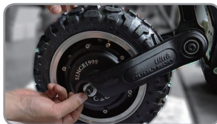
(8) Закрепите винты и болты, правильно установите корпус
