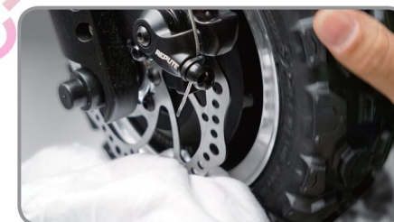
(4) Протрите внутреннюю сторону диска при вращении колеса
